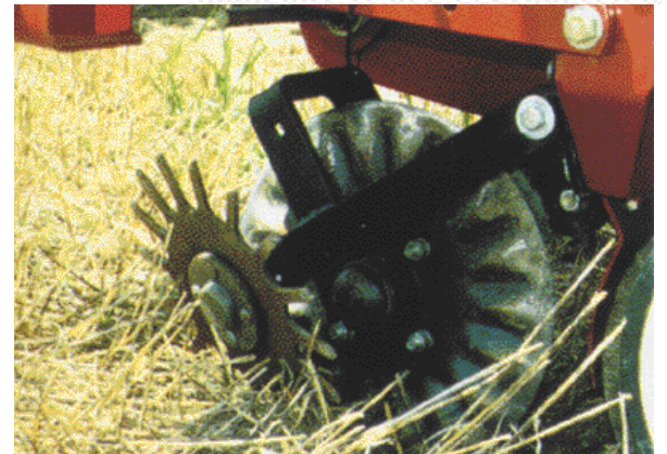
Semoir à maïs avec tasse-résidus en fonction dans des résidus de céréales
