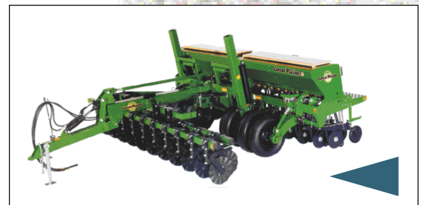
Semoir à céréales muni de coutres
