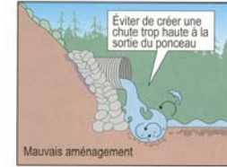
Figure 21 Absence de bassin de repos
