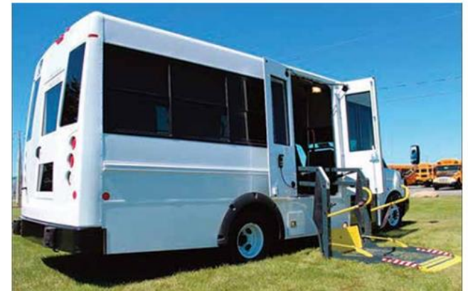
Figure 12. Le Girardin G5 et sa plateforme élévatrice. Source : Girardin-Blue Bird, 2017.
